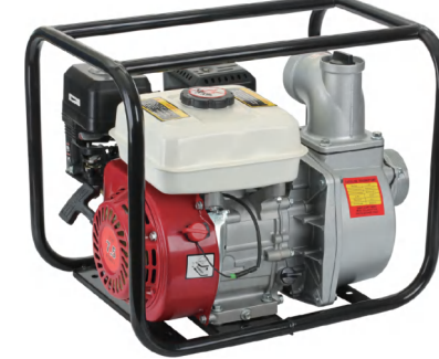
KF-300 尺寸 Dimension (mm) (L × W × H): 510 × 390 × 440 流量 Output (m³/h): 50 吸程 Suction Length (m): 8 扬程 Lift (m): 20 排量 Discharging capacity (ml): 163 动力 Power: 168F 出水口直径 Water Outlet Diameter (mm): 80 最大功率 Max power (kw/r/min): 3.7/4000
