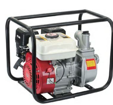
KF-200 尺寸 Dimension (mm) (L × W × H): 480 × 390 × 410 流量 Output (m³/h): 35 吸程 Suction Length (m): 8 扬程 Lift (m): 30 排量 Discharging capacity (ml): 163 动力 Power: 168F 出水口直径 Water Outlet Diameter (mm): 50 最大功率 Max power (kw/r/min): 3.7/4000
